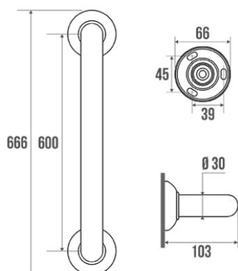
Tube aluminium blanc Ø 30 mm, platines et cache-fixations blanc en résine de synthèse, Ø 66 mm.
